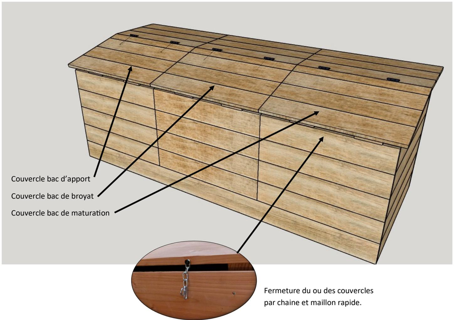
Maintien des capot ouverts par de puissants câbles en acier gainé de 4mm de diamètres et tenus des vis pentures 7/45.
