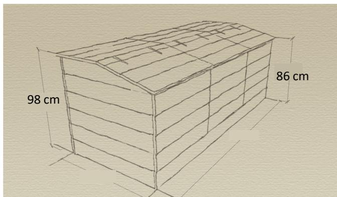
**Volume:** Meuble constitué de 3 bacs de 660 ou 860 litres (600 / 800 / 1000 litres pour le dépôt + **60 litres pour le dégazage**)
